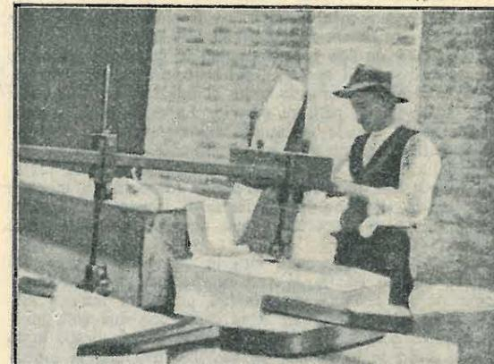
Fig. 11. — Macchina pneumatica per la lucidatura delle pietre.
